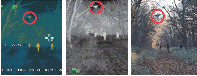
図-3 木に止まろうとするオオタカを撮影した画像 左から順に、一般用の赤外線サーモカメラ、動物調査用の赤外線サーモカメラ、ビデオカメラの画像。オオタカまでの距離は、約50mある。
