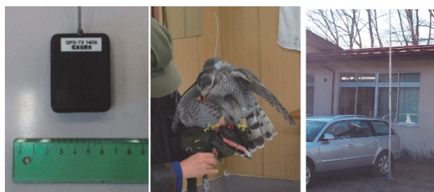
図-1 左図・中央図：オオタカに装着した電波発信機(GPS-TX)。右図：金属製ポールでできた簡易基地局の受信アンテナと設置の様子。
