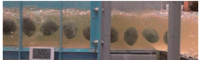
図-5 上流端流速 10m/s の流況(上)と高速撮影した礫の流下状況(下)
