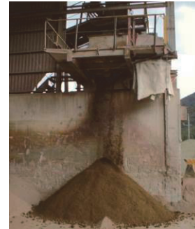
写真-4 GS石灰処理土GSソリッドの混合・造粒後の状態
