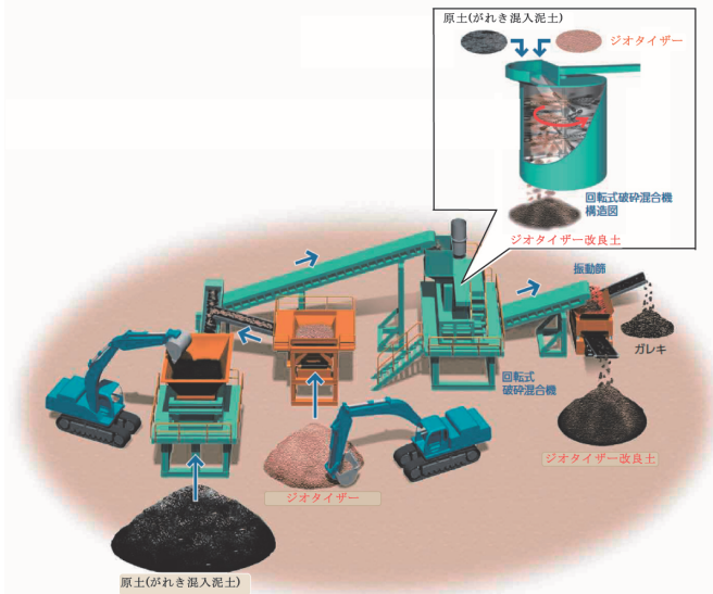
図-2 カルスピ工法の概要
