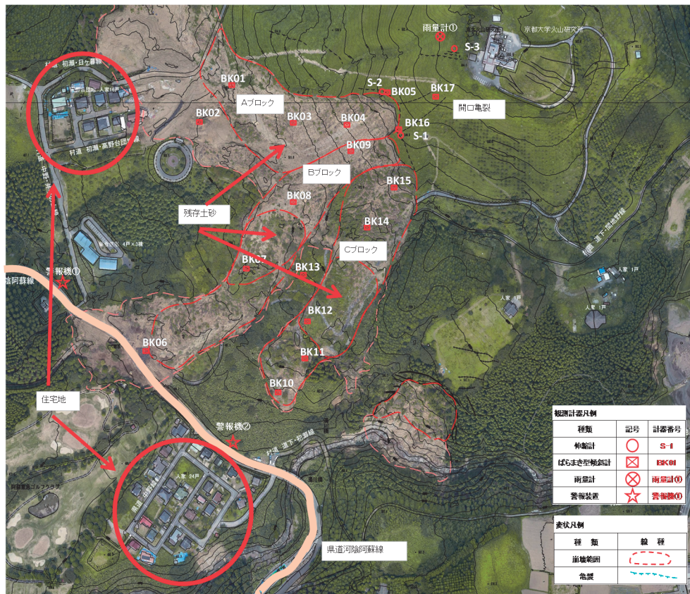
図-3 高野台の被災及び斜面監視機器設置状況
