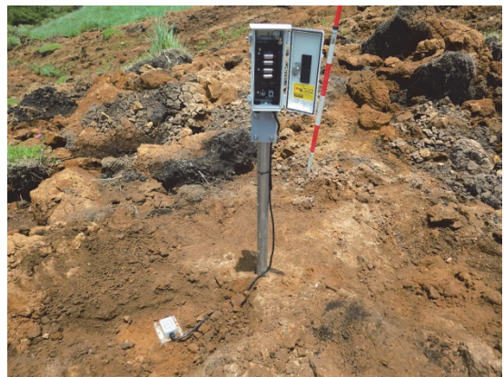
写真-4 ばらまき型傾斜計設置状況(BK01)
