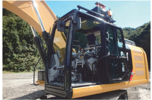
写真-10 簡易遠隔操縦装置搭載状況
