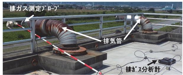
写真-7 排ガス測定状況
