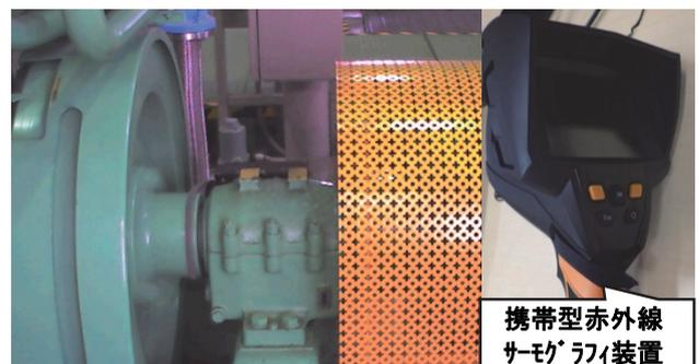
写真-5 軸受及び携帯型赤外線サーモグラフィ装置
