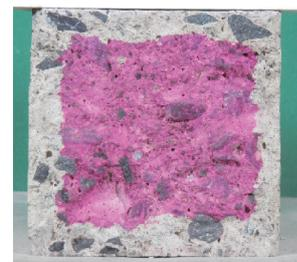
図-5 フェノールフタレイン溶液を噴霧した割裂面の例（上面が打設面）
