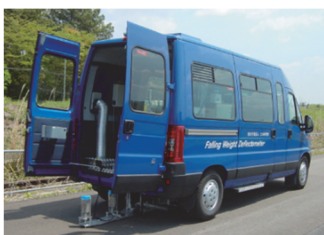
写真-1 FWDによる調査
