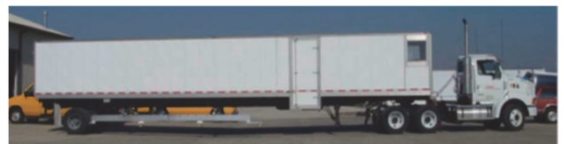
写真-2 米国で開発された移動式たわみ測定装置 4)
