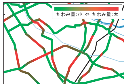
図-1 MWDによるネットワークレベルでの調査イメージ
