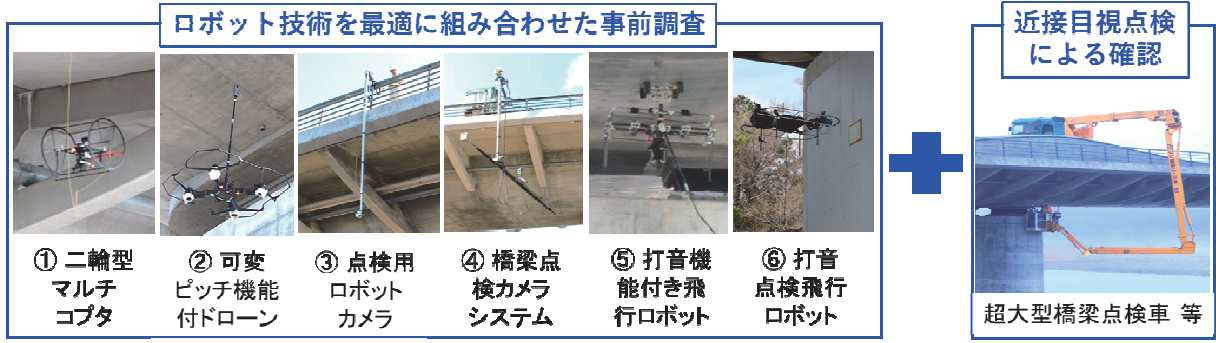
図-2 ロボット技術による事前調査の結果を踏まえた近接目視点検
