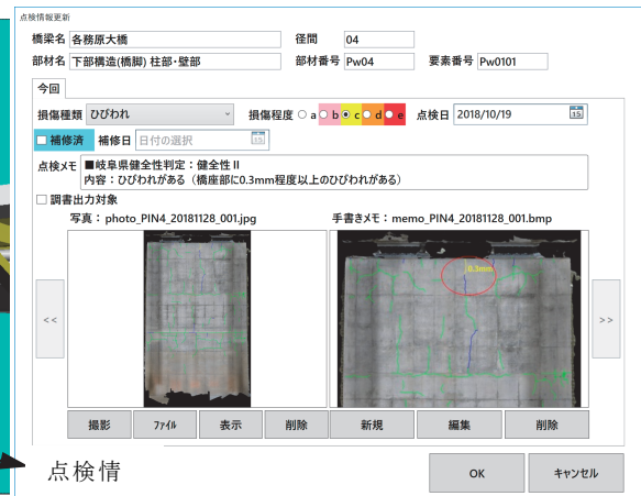
図-6 狭域調査結果の三次元変状マップと変状情報の紐づけ
