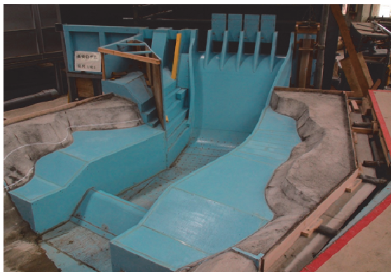
図-5 全体模型（縮尺 1/62.5）（左）と越流部抽出模型（縮尺 1/40）（右）
