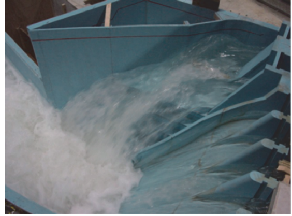
図-6 水理模型実験での流況（導流部：原案形状（左）、最終形状（右））
