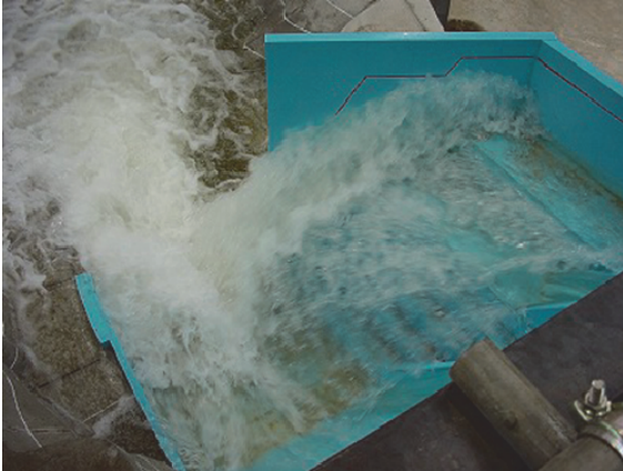
図-6 水理模型実験での流況（導流部：原案形状（左）、最終形状（右））
