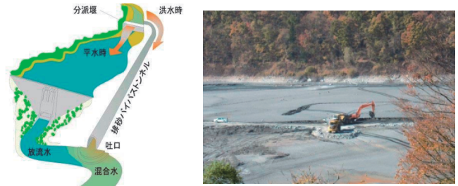
図-1 ダム貯水池堆砂対策の事例 3)
