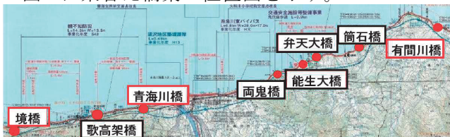
凡例: 架替え完了 事業中 (H31.4現在) 図-1 糸魚川地区塩害架替え橋梁位置図
