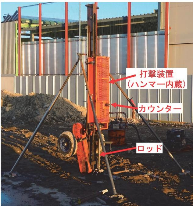
人力で移動するタイプ：移動時は横に倒す、車輪付き
