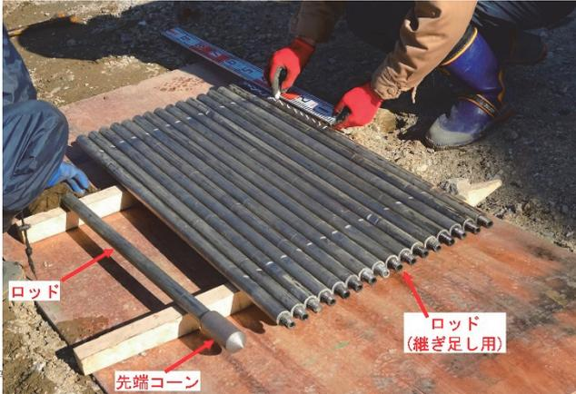
先端コーン：直径45mm、本写真例では使い捨て（引き抜き時に地中に残す）
