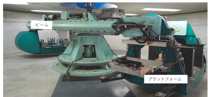
写真-1 使用した遠心力载荷試験装置
