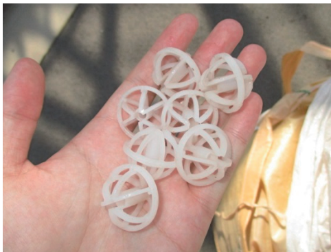
図-5 吸収塔内部（上）と吸収塔内部のろ材（下）
