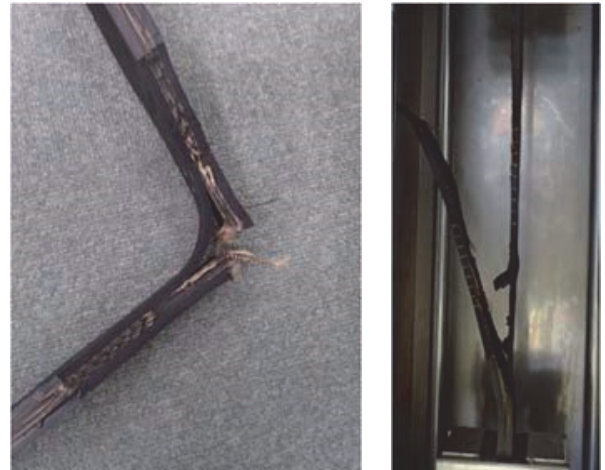
図-7 クリープ破断のモード (左:繊維破断型、右:せん断はく離型)
