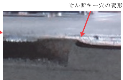
写真-3 A2橋台G4支承におけるゴム支承本体断面の損傷状態 (ゴム支承本体中央を切断)
