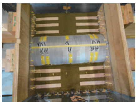
写真-6 帯状補強材の配置状況
