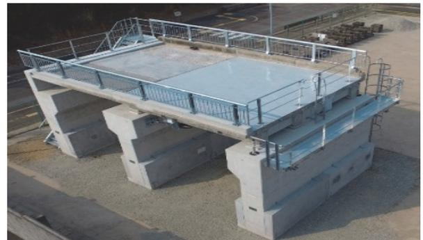
写真-3 橋梁損傷を再現した実モデル
