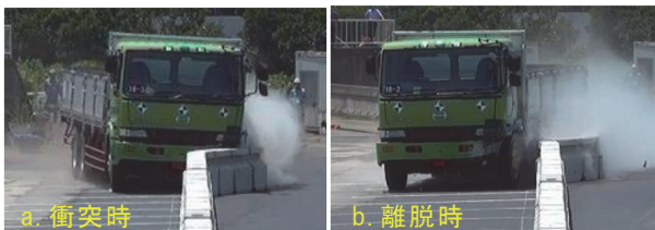
写真-2 車両の衝突状況
