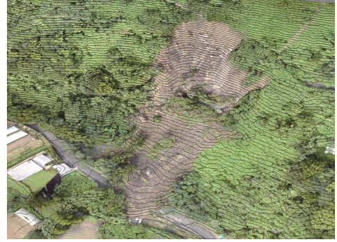
図-7 UAVレーザ測量成果を用いた三次元モデル
