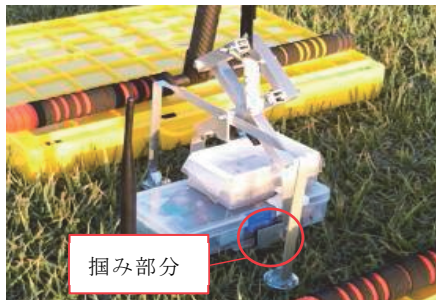
写真-1 把持部の構造（掴み型）
