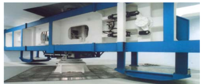
写真-1 土木研究所が所有する大型動的遠心力载荷試験装置
