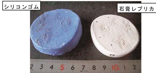
(4)石膏レプリカからこぶ状さびの腐食形状を計測する。具体的にはX-Yステージ上に石膏レプリカを置き、ダイヤルゲージにて各位置の深さを計測する。なお、測定する面の傾斜を考慮してデータを補正する。
