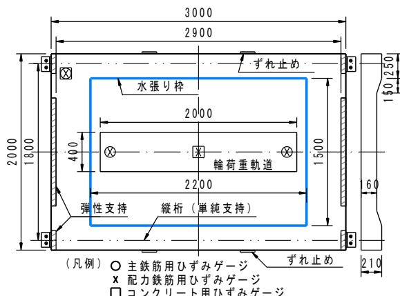
図-1 床版試験体形状及び支持条件
