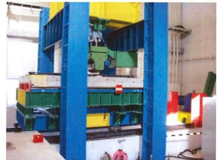
写真-4 輪荷重移動試験機 (台車走行型)
