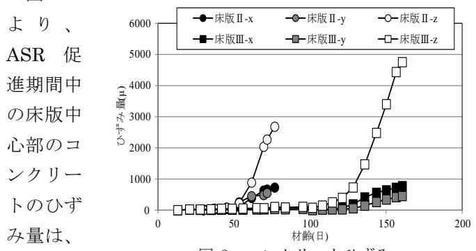
図-2 コンクリートひずみ
