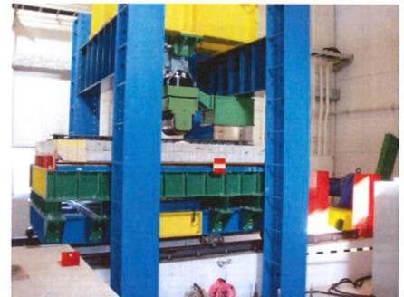
写真-4 輪荷重移動試験機
