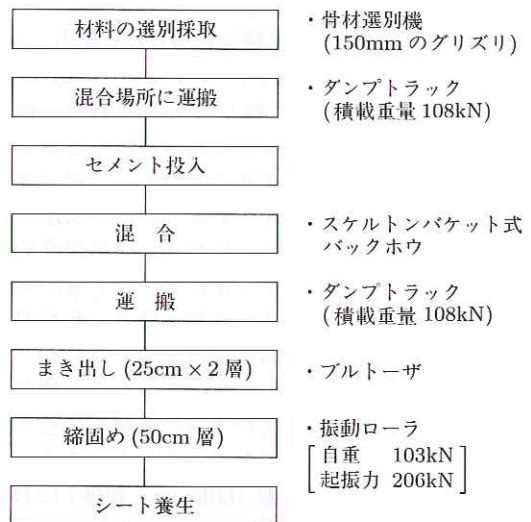
図-8 施工フローの一例
