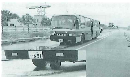
写真-1 すべり摩擦測定車
