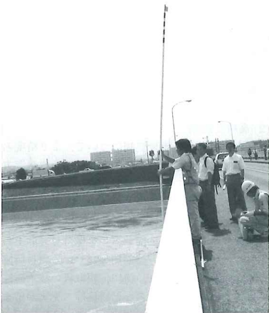
図-1 4m 吃水浮子の投下(利根川布川地点)
