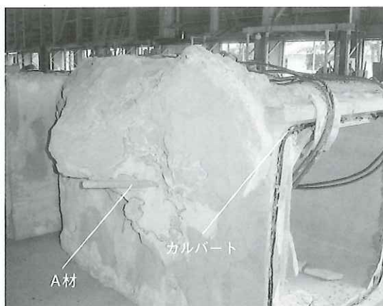
写真-3 A材による付着状況(一部)
