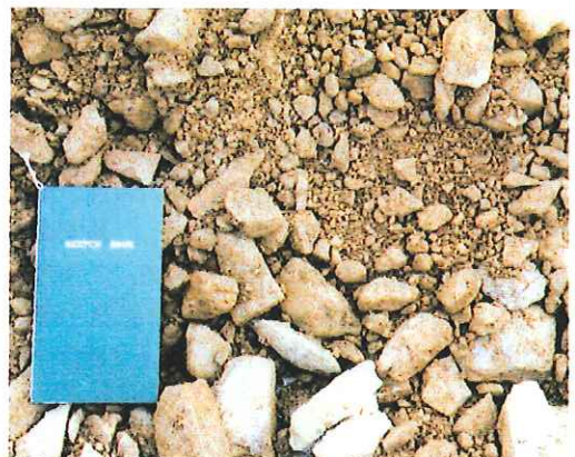
写真-2 掘削ズリを母材とした事例
