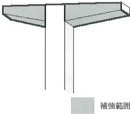
図-7 橋脚横梁部の剥落防止対策
