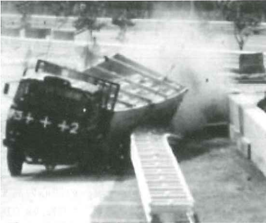
写真-1 防護柵の衝突実験
