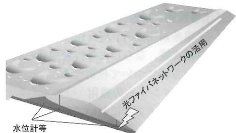
図-2 堤体内水位計測のイメージ
