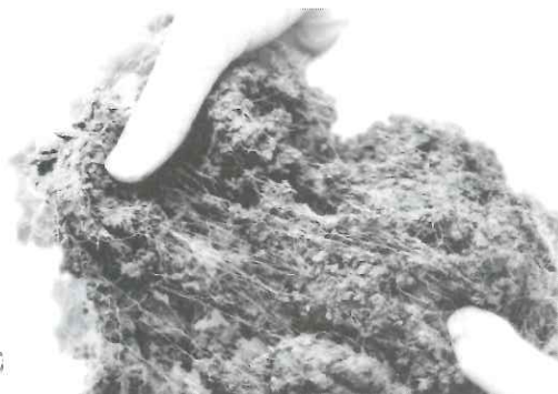
写真-1 短繊維混合補強土
