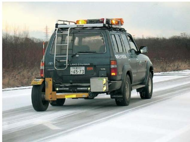
写真-3 連続すべり抵抗値の測定（苫小牧寒地試験道路）
