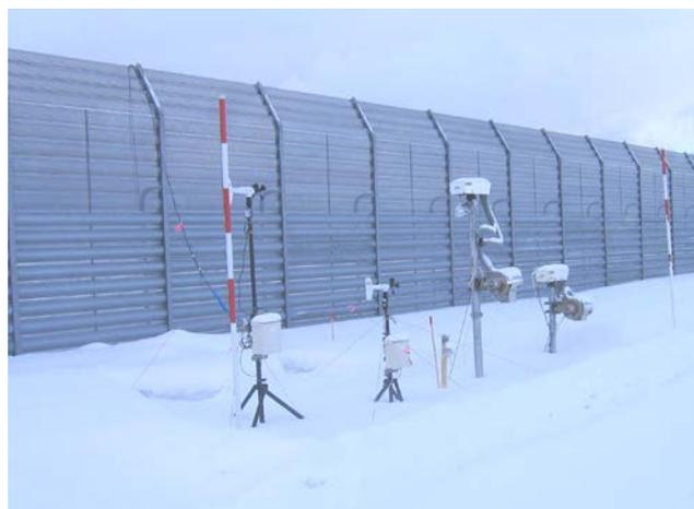
写真-4 防雪柵の性能計測（石狩吹雪実験場）
