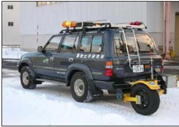
写真-1 連続路面すべり抵抗測定装置及び牽引車
