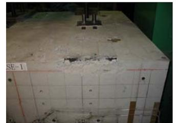
写真-6 上面の破壊状況
