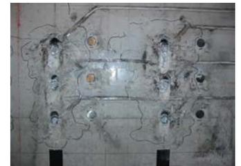
写真-4 側面アンカー破断状況
