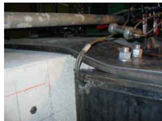
写真-5 縁端部における上面鋼板の接触状況
