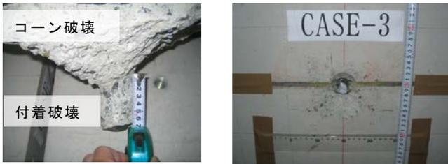
写真-1 引抜き破壊 (CASE2) 写真-2 せん断破壊 (CASE3)
