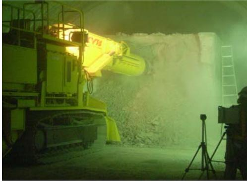
図-3 模擬岩盤コンクリート掘削状況
