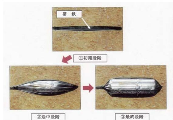
図-8 袋状の薄い鋼板を用いた拡径型アンカー工法の施工方法<sup>5)</sup>
