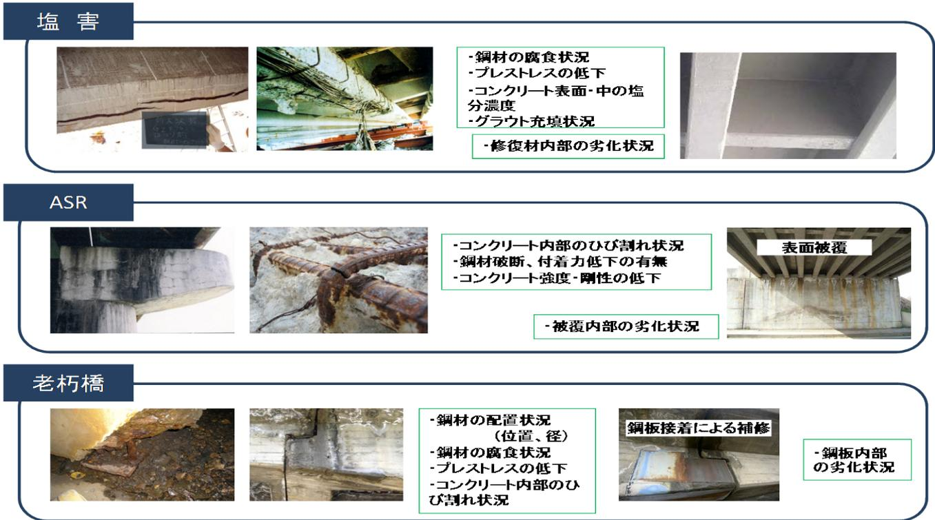
図-1 コンクリート道路橋の診断高度化のために非破壊検査に求められる調査項目例
