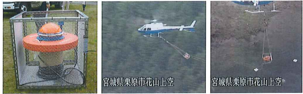
図-5 投下型水位観測ブイの外観と設置状況 (左:ブイ外観、中:ヘリコプターで輸送中の様子、右:設置中)
