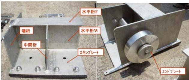
写真-2 暴露試験ユニット外観
