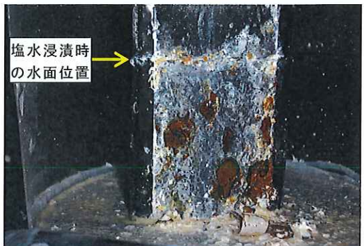
写真-9 境界部の試験(塩水浸漬約1年後)
