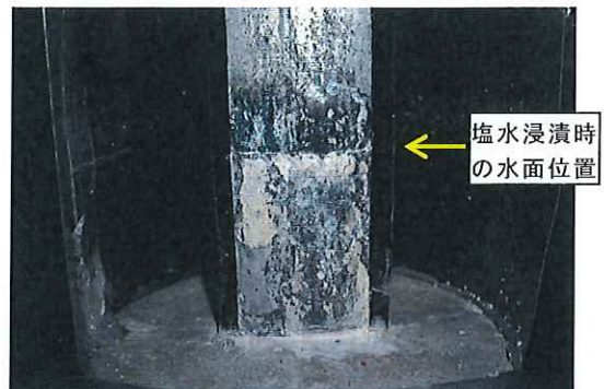
写真-7 境界部の試験(塩水浸漬1ヶ月、気中1年放置)
