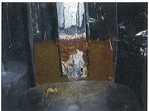
写真-10 境界部の試験(塩分を含む土中1年後)
