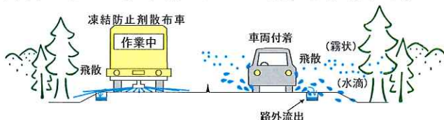
図-1 散布した凍結防止剤の飛散イメージ
