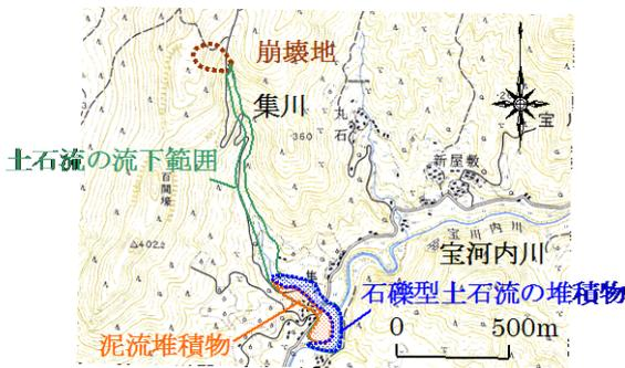
図-2 検討対象事例の土石流流下状況
