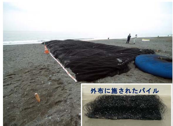
写真-1 施工直後の試験体A
