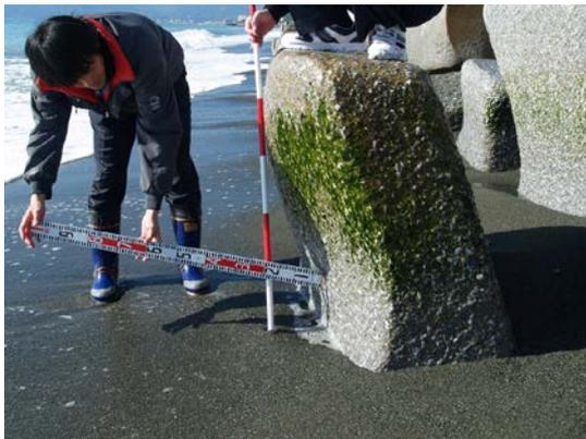
写真-7 コンクリートブロックの摩耗状況
