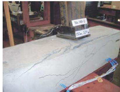
写真-1 地覆破損状況（150mm変位時の例）
