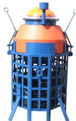
写真-1 土研式水位観測ブイ（投下型）
