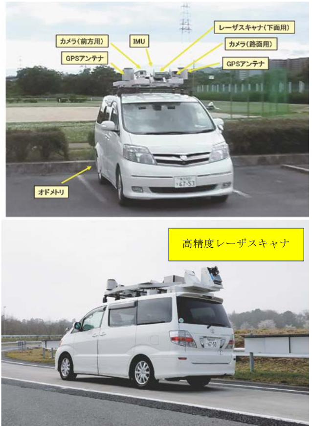
写真-2 改良したMMS
