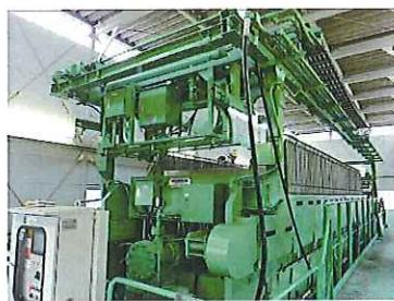
写真・1 高圧機械脱水 (PFP) 機
